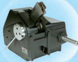
NPW4610 积极式凸轮开口（下置） 【应用范围】：适用于各种喷水织机，门幅 190cm，4/1 组织，转速达 800r/min 【箱体与间距】：最大 10 页提升单元，间距为 12mm，开口量 55mm~115mm 【控制系统】：织机内部控制器 【循环纬数】：纬丝循环数 6 纬以内
