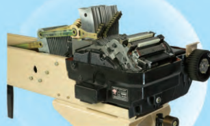
NP5400A 积极式电子多臂 【应用范围】适用于各种喷水、喷气织机，转速达 800 r/min。 【箱体与间距】最多 16 页提升单元，间距为 12mm。 【控制系统】电子式；或织机内部控制器。 【循环纬数】根据控制器变化，循环纬数 13000 纬以内。
