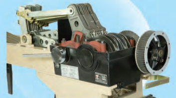
NPW408A 积极式凸轮开口（高速） 【应用范围】适用于各种喷水织机，门幅 190cm, 1/4 组织，转速达 800 r/min。 【箱体与间距】最大 10 页提升单元，间距为 14mm，开口量 47mm~113mm。 【控制系统】织机内部控制器。 【循环纬数】纬丝循环数 10 纬以内。
