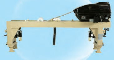
NPGD50 消极式多臂 【应用范围】适用于各种喷水、喷气织机，转速达 650 r/min。 【箱体与间距】最多 16 页提升单元，间距为 12mm。 【控制系统】织机内部控制器。 【循环纬数】纬丝循环数 312 纬以内。
