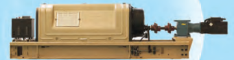
NP6000 系列电子提花机 【应用范围】适用于喷水、喷气、剑杆、片梭等各类无梭织机，特别适用于大花型织物，最高速达 650r/min 【提花针数】1408~19456 针 【开口】复式全全清晰开口，开口量 46mm~130mm 【控制系统】电子式控制器 【循环纬数】任意循环纬
