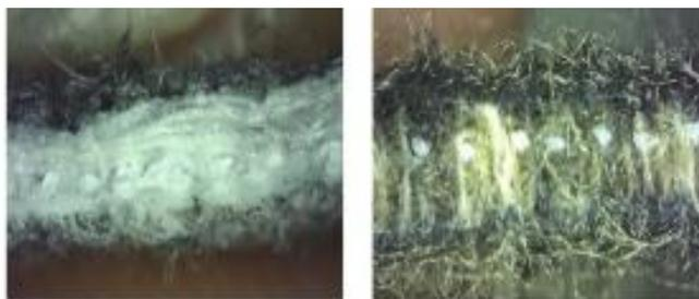
a) 高精度复合滤袋使用3个月后      b) 原失效滤袋
