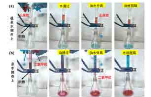
图7 Janus织物对混合液(a)水/正庚烷(轻油)和(b)水/二氯甲烷(重油)的油水分离情况
